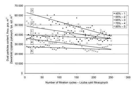
Fig. 2. Number of dust particles in air cleaned on hydrophobically appred unwoven fabric Rys. 2. Liczba cząstek pyłowych w oczyszczonym powietrzu po stosowaniu włókniny apreturowanej hydrofobowo
