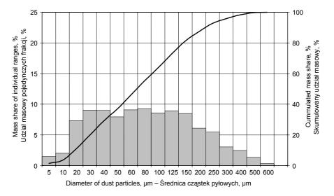
Fig. 1. Grain composition of dust Rys. 1. Skład ziarnowy pyłu
