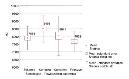
Fig. 1. Average calorific values of 1 m<sup>3</sup> of fir timber for the current period Rys. 1. Średnie wartości ciepła spalania 1 m<sup>3</sup> drewna jodły olbrzymiej w okresie bieżącym
