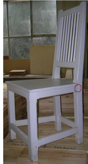
Fig. 1. Examined tenon joint of the backrest leg with the side underframe Rys. 1. Badane połączenie czopowe nogi oparciowej z oskrzynią boczną krzesła
