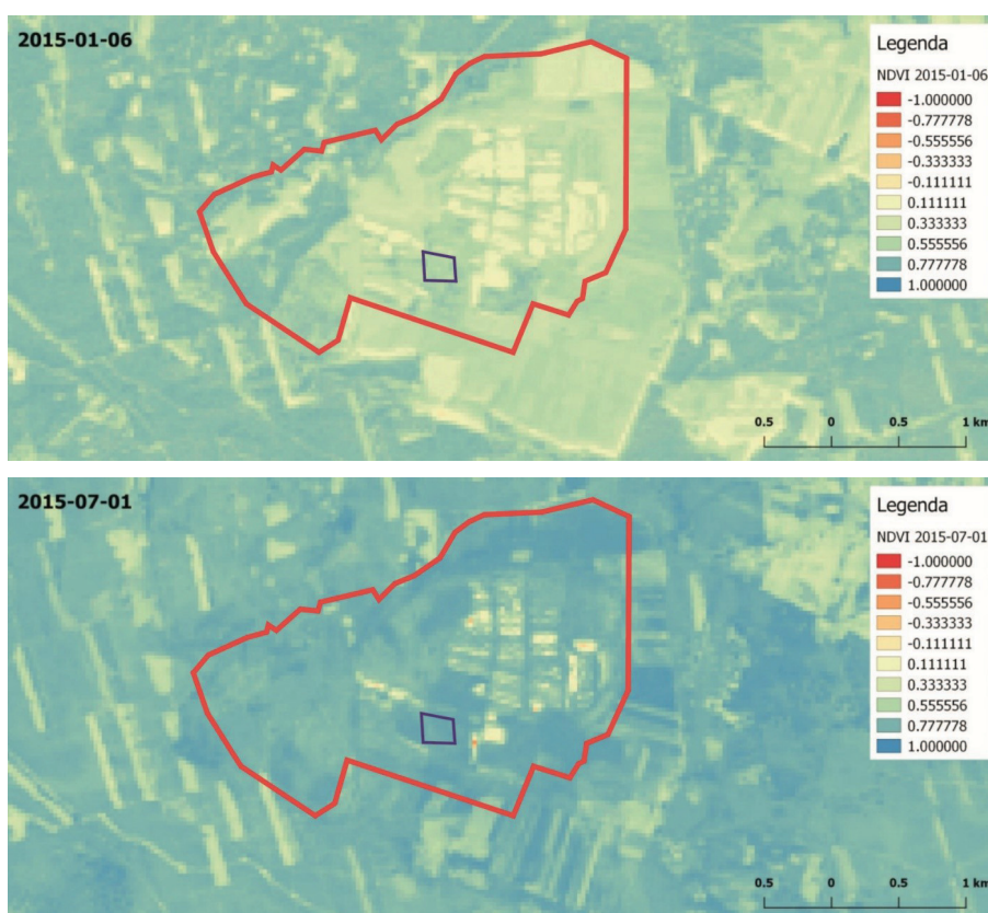
Rys. 3. Przykład analizy NDVI – porównanie zobrażeń Landsat 8 OLI z 2015-01-06 oraz 2015- 07-01 (http, 2015a; http, 2015c)
