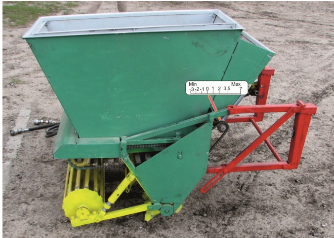
Fig. 4. Dispense outlet regulating lever with position scale Rys. 4. Dozownik z widoczną skalą położenia dźwigni regulującej wielkość wylotu
