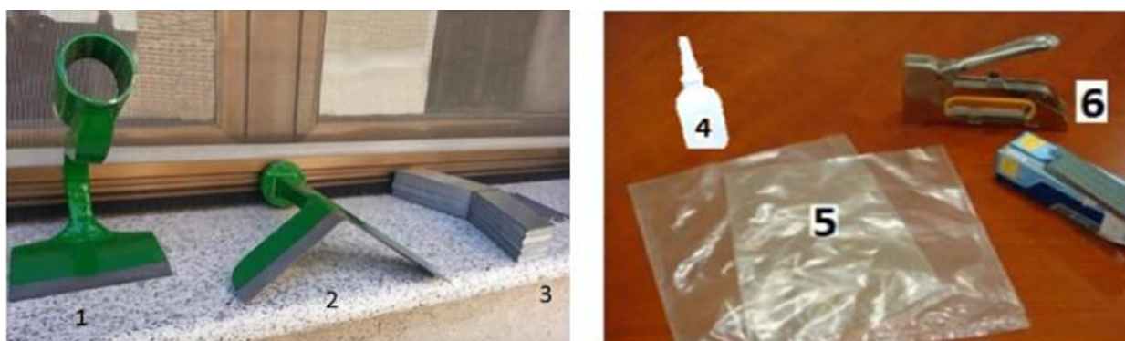
Fig. 4. (1) Bark peeling and smoothing tool; (2) groove-cutting tool for resin flow; (3) resin flow gutter; (4) plastic bottle; (5) plastic collection bag; (6) stapler (used for attaching the bag to the tree surface or resin collection system) (Deniz, 2018) Ryc. 4. (1) Narzędzie do zdejmowania i wygładzania kory; (2) Narzędzie do nacinania rowków dla przepływu żywicy; (3) Rynna do zbierania żywicy; (4) Butelka plastikowa; (5) Plastikowa torba zbierająca; (6) Zszywacz (używany do przymocowania torby do powierzchni drzewa lub systemu zbierania żywicy) (Deniz, 2018)
