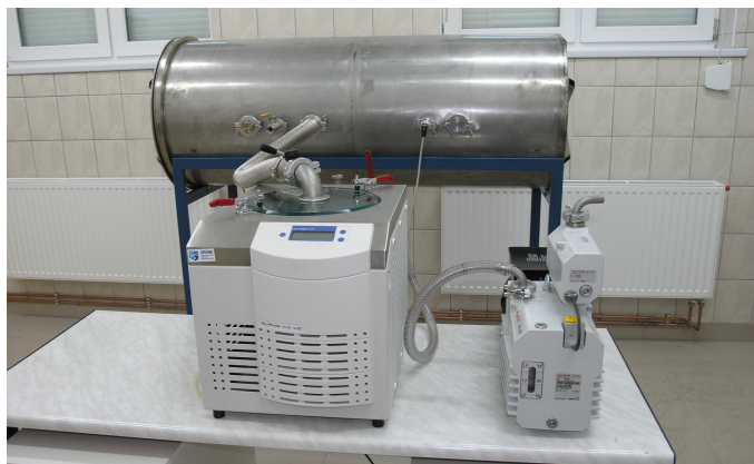
Fig. 1. Equipment for freeze-drying of the organic materials in the conservation laboratory at the Archaeological Museum in Biskupin Rys. 1. Zestaw do sublimacyjnego suszenia materiałów organicznych w pracowni konserwatorskiej Muzeum Archeologicznego w Biskupinie
