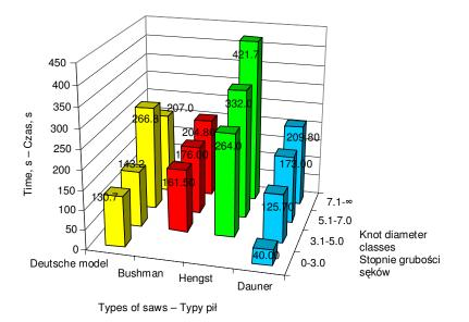
Fig. 7. Mean pruning time depending on knot diameters Rys. 7. Średni czas podkrzesywania w zależności od grubości sęków
