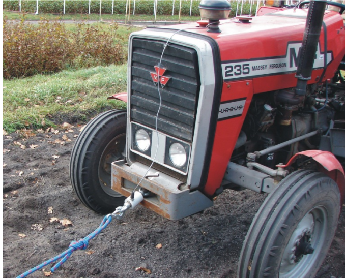
Fig. 2. Tractor MF 235 with attached force gauge EMS 150 and polypropylene line connecting both tractors Rys. 2. Ciągnik MF 235 z przyłączonym czujnikiem siły EMS 150 i linią polipropylenową łączącą ze sobą dwa ciągniki
